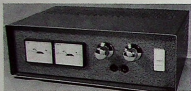
Bild 1. Frontansicht des Universal-Ladegerätes für Auto- und Kleinakkus
