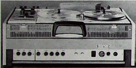
Bild 5. Versenkte Anordnung der Anschlußbuchsen
